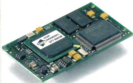
Das Modul basiert auf dem Intel XScale PXA270-Prozessor
