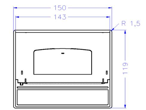
Abbildung 1: Abmessungen für GeBE-MULDE Maxi in mm
